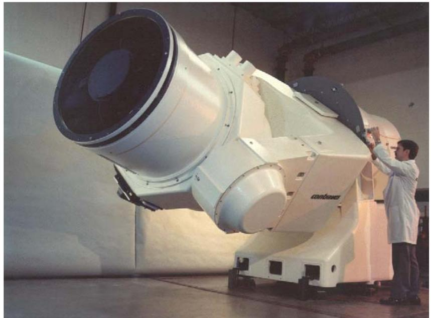
Abb. 3: Das erste 1 Meter GEODSS Teleskop des NEAT-Suchprogramms der USAF und NASA auf Hawaii von 1995 (Quelle: JPL/NASA)
